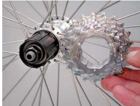
اتصال چرخ زنجیر عقب دوچرخه به محور آن
