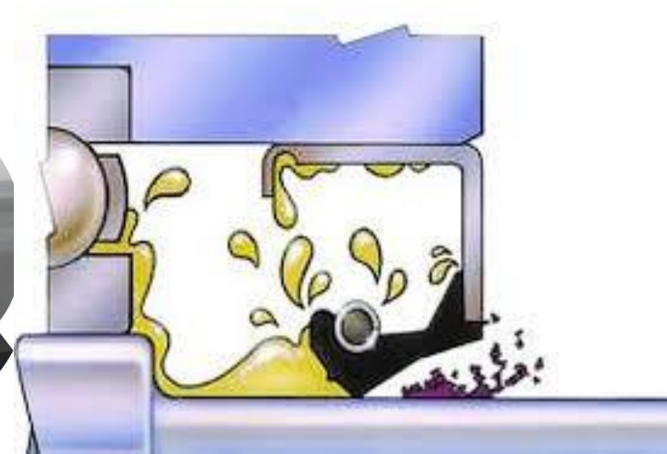
محافظت بلبرینگ با کاسه نمد (سمت چپ: گرد و خاک، سمت راست: روغن)
