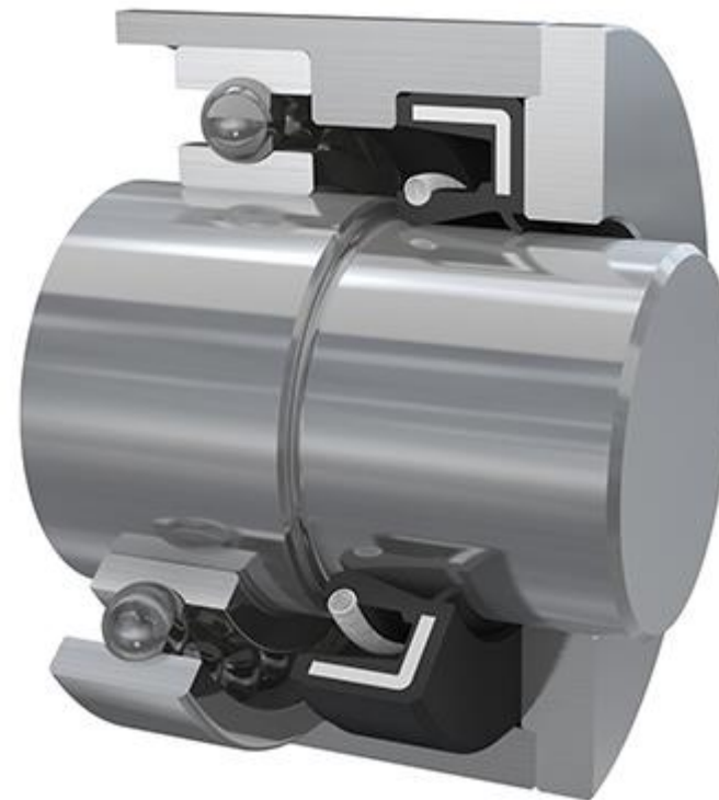
نمای سه بعدی از نحوه قرارگیری کاسه نمد برای محافظت از بلبرینگ.
