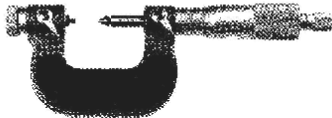
شکل ۶-۲: میکرومتر دنده پیچ [۶]
