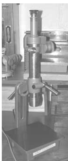
شکل ۱-۱۶: نمای میز گردان و یک دستگاه انگل دکور (Angle Dekkor)
