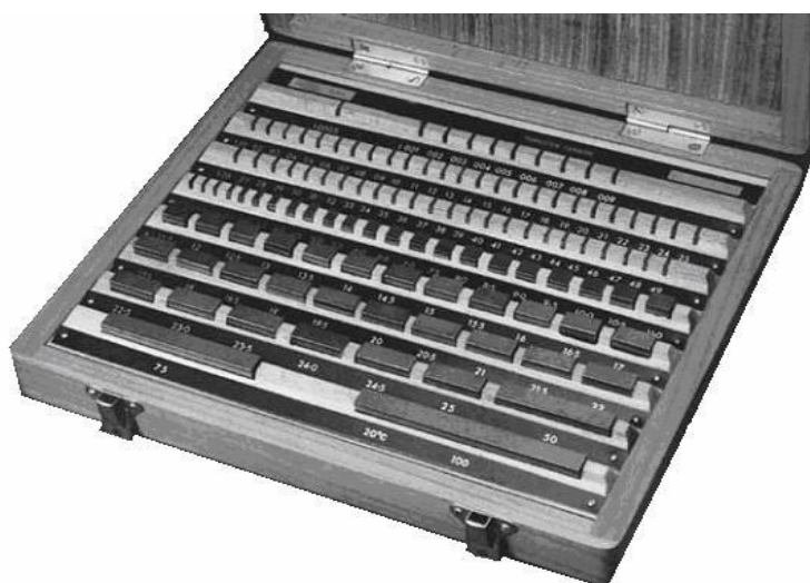
شکل ۵-۱: جعبه قطعات اندازه (فولادی) [۵].
