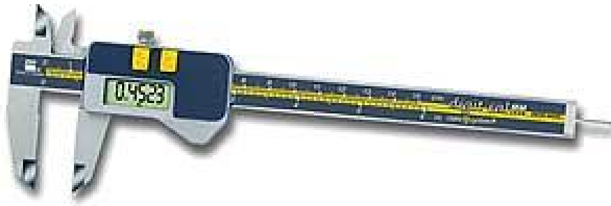
شکل ۴-۳: کولیس با نشان دهنده دیجیتالی.
