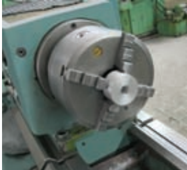
شکل ۲-۸ بستن قطعه کار با مقطع گرد
