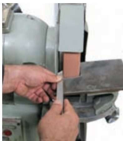
شکل ۴-۱۱ تیز کردن زاویه براده
