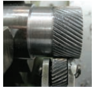
شکل ۹-۱۳ بعد از انجام آج زنی قطر قطعه افزایش می یابد
