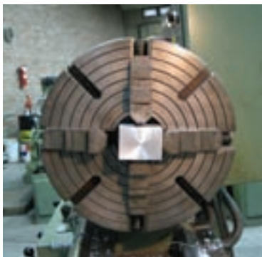
شکل ۲-۱۰ بستن قطعه کار با مقطع مستطیل شکل
