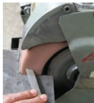
شکل ۴-۹ تیز کردن زاویه آزاد پیشانی
