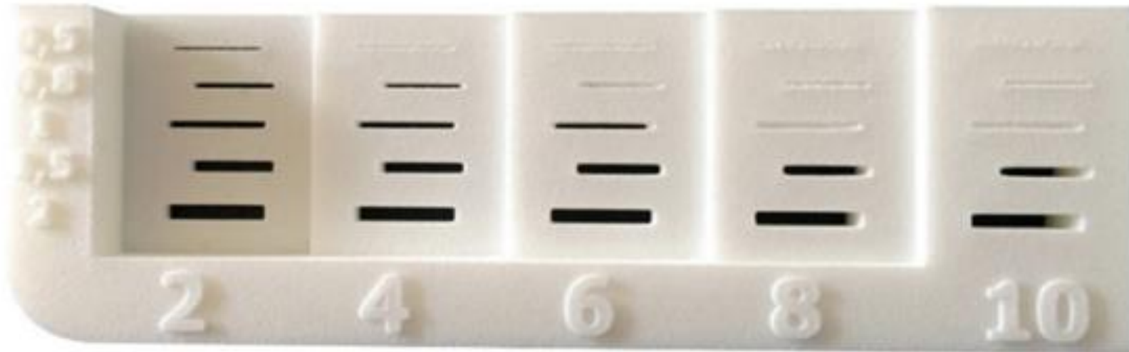
شکل ۳-۳ اندازه سوراخ بستگی به ضخامت مواد دارد
