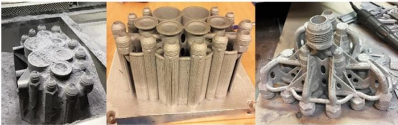
شکل ۳-۱۷ منیفولد هیدرولیکی برای AM با پودر خارج‌سازی نشده (سمت چپ)، ساختارهای نگهدارنده متصل (وسط) و مواد نگهدارنده جدا شده (راست) طراحی شده است
