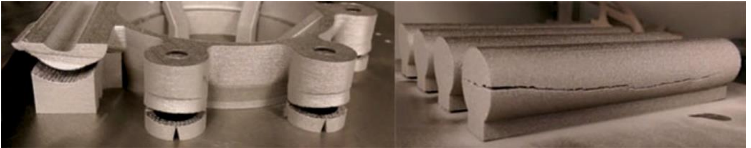
جدا شدن از صفحه ساخت و یا ترک خوردن قطعه ناشی از تنش پسماند
